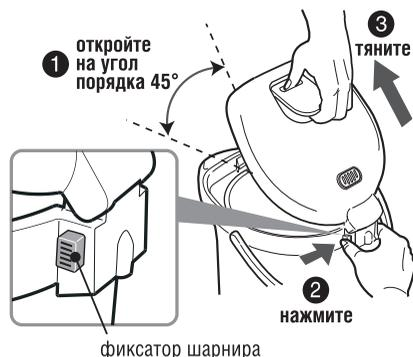
Чтобы вернуть крышку на место, вставьте ее в шарнир под углом порядка 45° с небольшим усилием. Посадка крышки в шарнир сопровождается легким щелчком.
