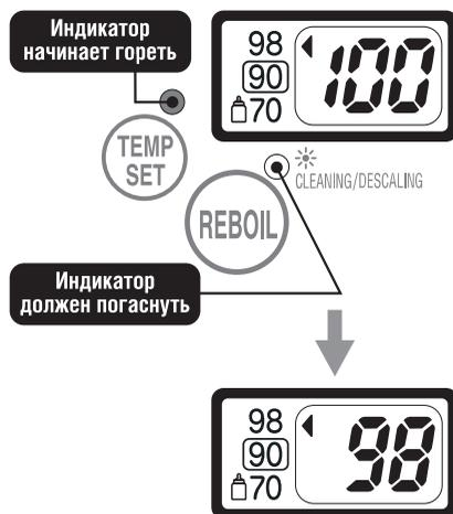
После того, как вода вскипела, индикатор кипячения погаснет, а индикатор сохранения тепла загорится. Когда температура воды опустится до 98°C, на
