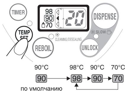
Если вы хотите, чтобы термопот поддерживал после кипячения другую температуру жидкости, воспользуйтесь кнопкой установки температуры TEMP SET, пока вода закипает. Каждое нажатие этой кнопки перемещает указатель-треугольник на жидкокристаллическом дисплее на следующую позицию, задавая соответствующий режим.
