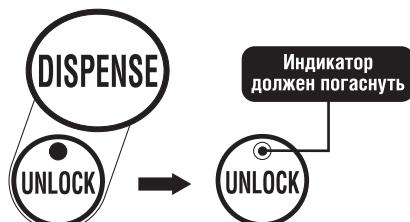
снятия. Эта функция предотвращает выливание горячей воды, если вы нажали на кнопку включения электрической помпы DISPENSE по ошибке.
